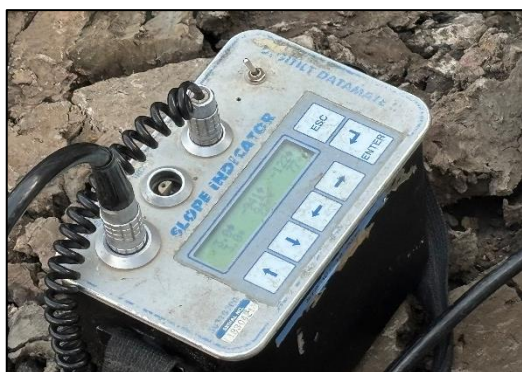
รูปที่ 6 เครื่องมือวัดการเคลื่อนตัวของดิน
